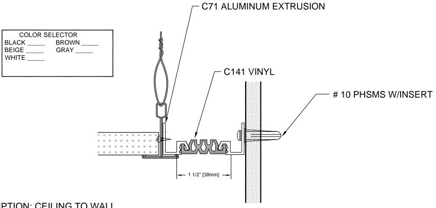
DESCRIPTION: CEILING TO WALL ALUMINUM: 6063-T5 EXTRUSION
